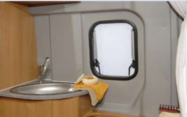
Kastenwagen – Innenausbau Material: ABS – Co-extrudiert
